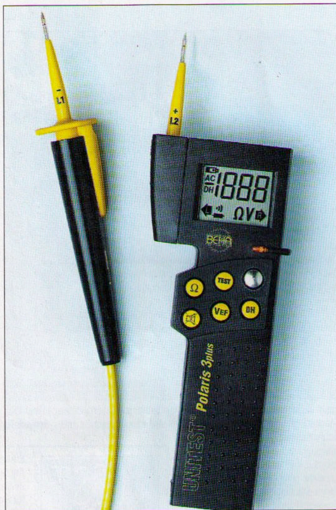
Spannungsprüfer „Polaris“ mit patentiertem Klappmechanismus für die Mess-Spitzen, ausgezeichnet beim internationalen Designpreis Baden-Württemberg 2000 des Designcenters Stuttgart Bild: Privat
