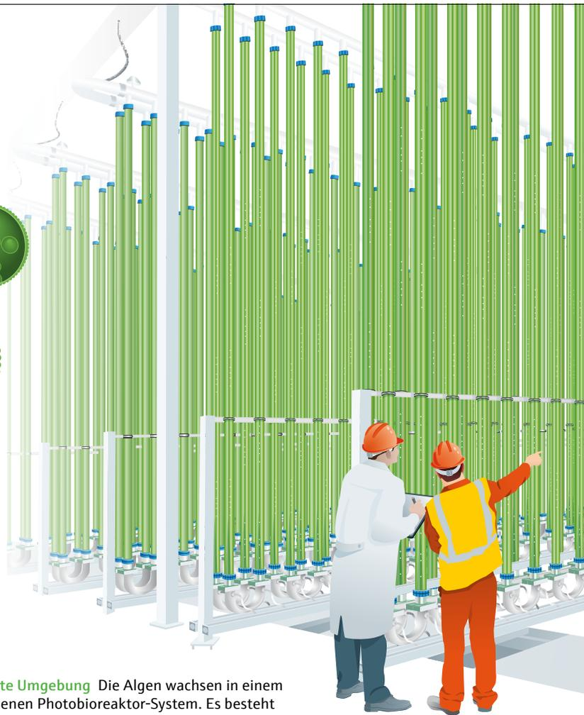
**Geschützte Umgebung** Die Algen wachsen in einem geschlossenen Photobioreaktor-System. Es besteht aus 43.000 Glasröhren, die jeweils sechs Meter hoch und mit Trinkwasser gefüllt sind.
