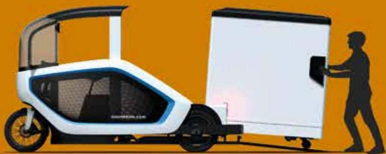
Der Container wird über im Fahrzeug mitgeführte Rampen auf die Ladeplattform geschoben, bis er einrastet. Mittels kontaktloser Rechtevergabe kann festgelegt werden, wer mit dem RFID-Chip den Container öffnen und schließen darf.
