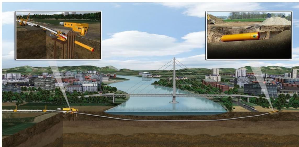
Abbildung 9: Das Direct Pipe®-Verfahren: Pipeline-Verlegung in einem Schritt.
